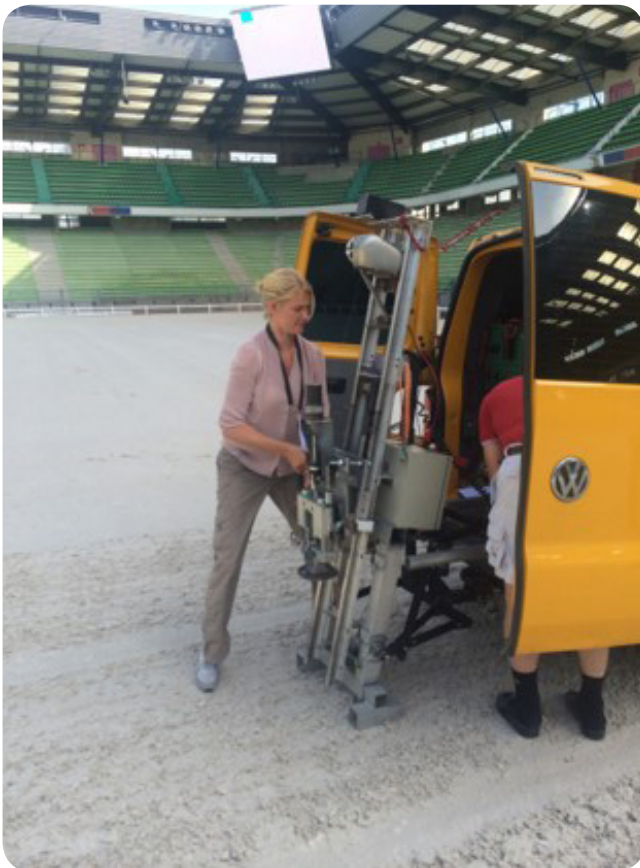
Abb. 4: Orono Biomechanical Surface Tester im Einsatz (Mit freundlicher Genehmigung von Michael Peterson) / Orono Biomechanical Surface Tester in action (Courtesy of Michael Peterson)
